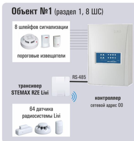
Рис. 4.8. Пример топологии сети RS-485 объектового оборудования при использовании трансивера STEMAX RZE Livi
