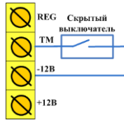
Рис. 4.6. Схема подключения скрытого выключателя или кнопки
