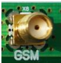
Рис. 4.3. SMA-разъем для подключения GSM-антенны
